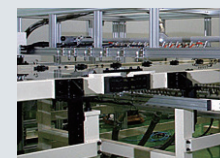
3 평활도 유지 일정한 압력의 공기를 쏘아 패널의 평활도를 유지
